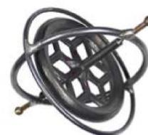
Wird durch eine äußere Kraft  $\vec{F}$  die Drehachse des Kreisels um den Vektor  $\vec{r}$  (vom Drehpunkt zum Angriffspunkt der Kraft) gekippt, resultiert daraus ein Drehmoment  $\vec{M}$ .
