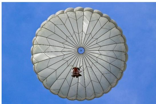
ABBILDUNG 7. Ein geöffneter, runder Fallschirm: Das Loch in der Mitte dient der Stabilisierung.
