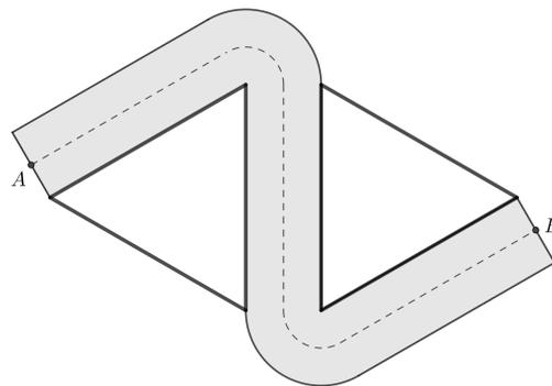
**Lösung:** In folgendem Bild ist die Aufteilung der Straße in Rechtecke und Kreissektoren angedeutet.
