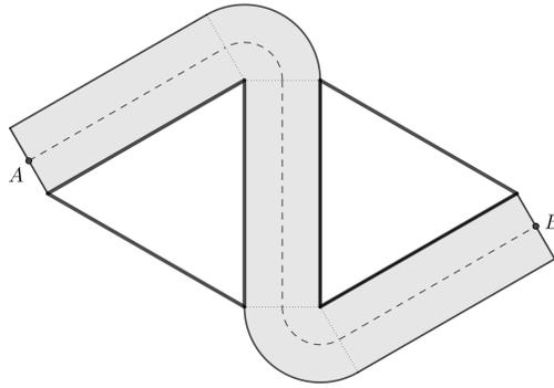
Die Mittellinien der Rechtecke haben dieselbe Länge wie die Dreiecksseiten, also jeweils 60 m. Die Mittelkurven der Kreissektoren sind Kreisbögen mit dem Radius  $\frac{1}{2} \cdot 20 = 10$  m. Der Zentriwinkel dieser Bögen ist jeweils gleich  $360^\circ - 2 \cdot 90^\circ - 60^\circ = 120^\circ$ , also genau ein Drittel des vollen Winkels. Jedes dieser Kreisbögen hat also die Länge  $\frac{1}{3} \cdot 2 \cdot 10 \cdot \pi = \frac{20}{3} \cdot \pi$ . Die Gesamtlänge der Leitschiene beträgt somit
